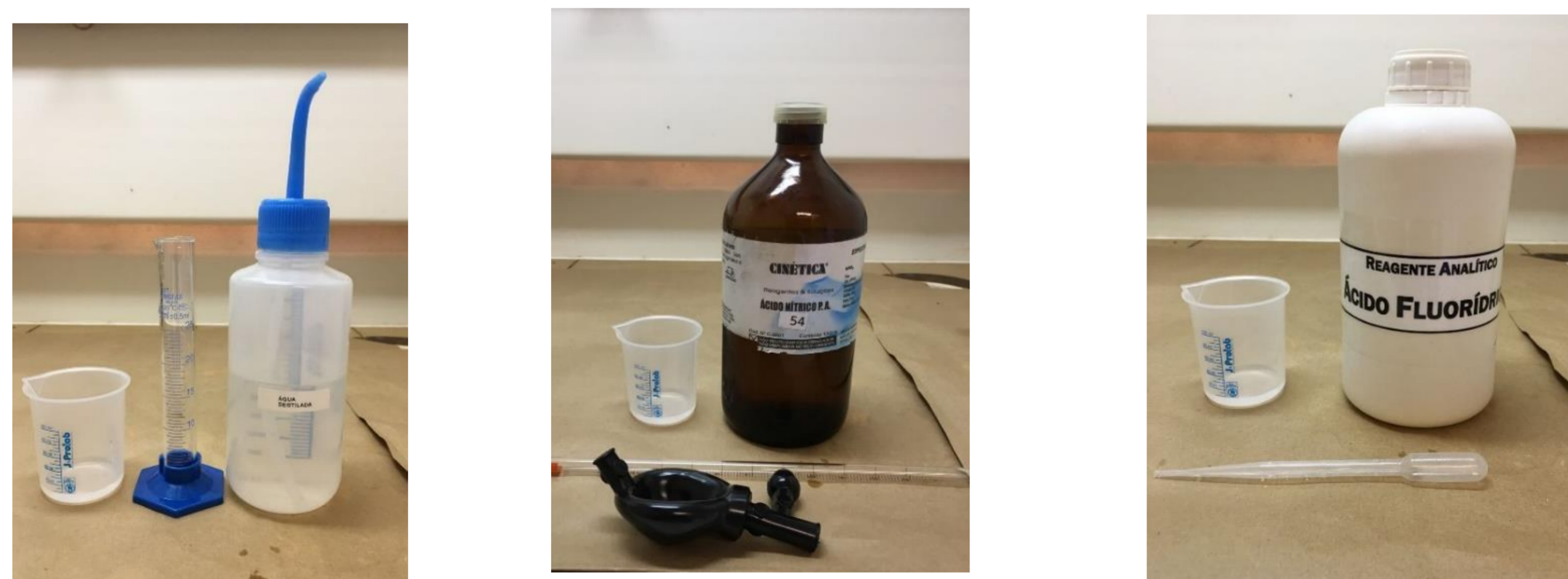
Figura 1: Bancada de preparação da solução em água de 10% HF e 5% HNO 3 .
