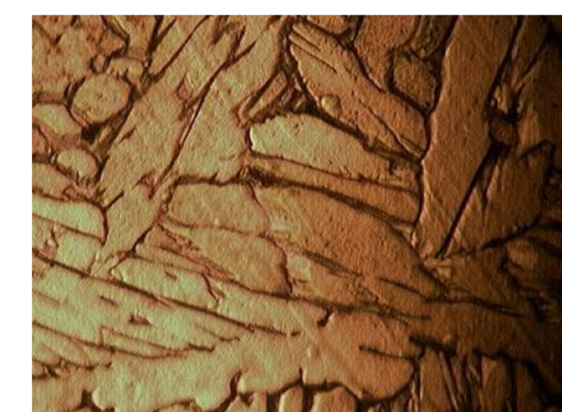
Figura 3: Análise microscópica da amostra TAV2 (600 X). microestrutura do tipo Widmanstätten (600X).
